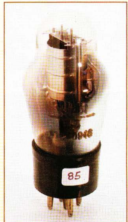
Obr. 2. Elektronka typu VT51, kterou byly osazovány vysílače souprav TR9
